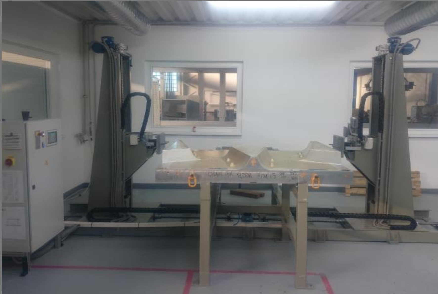
Otáčacie zariadenie na manipuláciu s formami veľkých rozmerov
